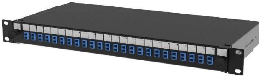
El panel de conexión deslizante acepta 24 adaptadores SC Simplex o LC Duplex en un espacio de 1U. El panel se puede precargar completamente con los adaptadores necesarios o precargar con pigtales y accesorios de empalme. La bandeja está bloqueada por 2 pestillos de plástico y baja a un ángulo de 45 grados cuando está completamente extendida. La instalación y el etiquetado son simple y fácil.
